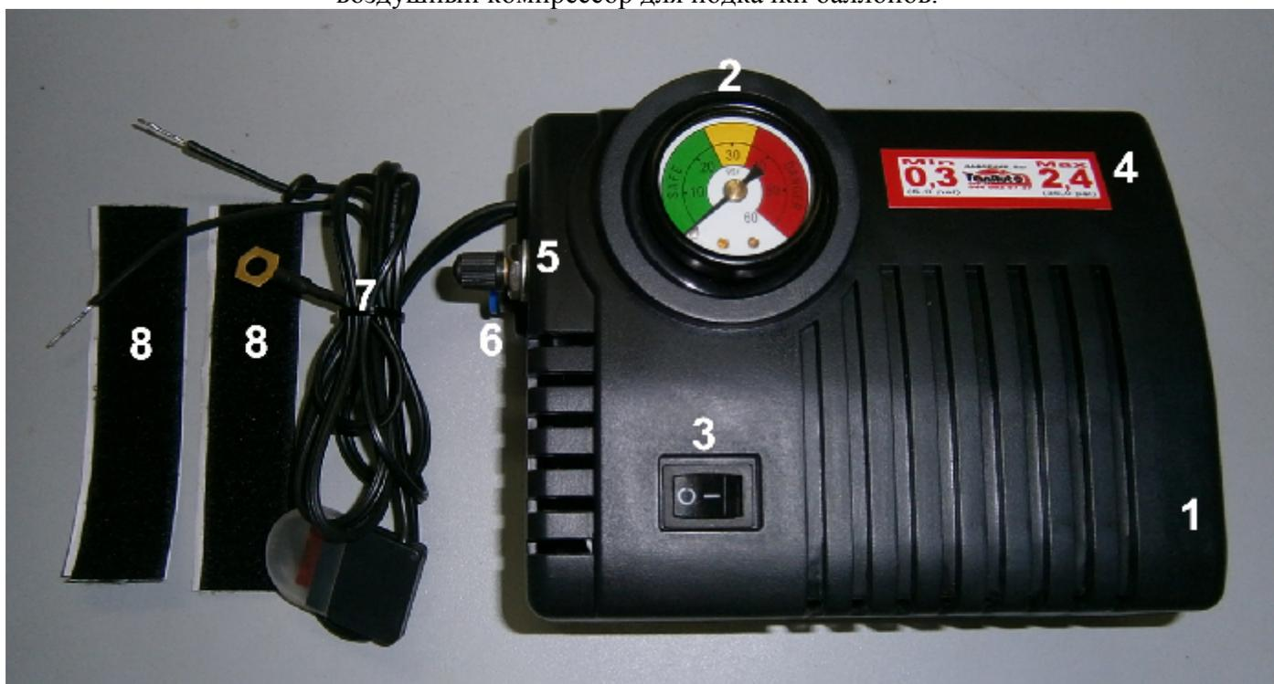
На лицевой панели блока 1 находятся: механический манометр 2, выключатель питания 3, табличка 4 с указанием рабочего диапазона давлений в баллонах.
